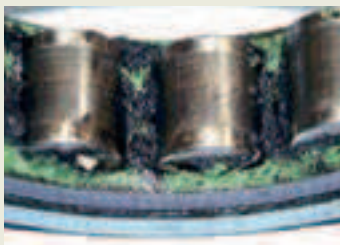
Degradacja smaru spowodowana prądami wyładowań elektrycznych
