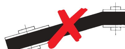
Płaszczyzny kół nierównoległe, nie leżą w jednej osi
