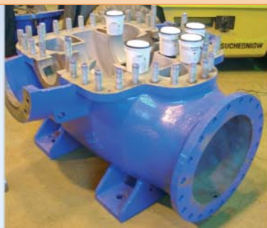
Rys. 2: Powierzchnia była poddana obróbce strumienio-ściernej do profilu 75 µm
