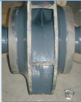
Wżery na wirniku zostały wypełnione przy pomocy szpachli Loctite® Superior Metal. Całość została pokryta produktem Loctite® Nordbak® 7227.
