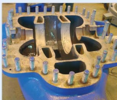
Rys. 4: Cała powierzchnia wewnątrz pompy zabezpieczona podwójną warstwą
