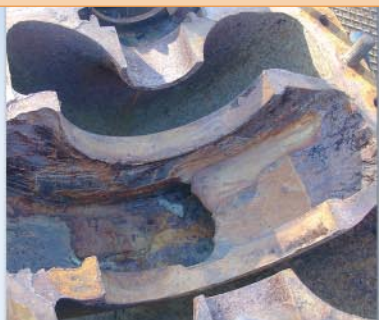
Rys. 1: Widoczna korozja i erozja
