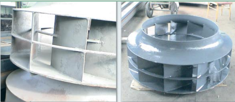
Dwa wirniki przed obróbką strumieniowo - ścierną
