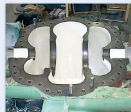
Naprawa zużytego i skorodowanego wału przy użyciu Loctite® 3478 Superior Metal, po utwardzeniu należy poddać go obróbce mechanicznej. Wszystkie elementy należy zabezpieczyć przy pomocy Loctite® Nordbak® 7228 Brushable Ceramic White (posiada certyfikat dopuszczający do kontaktu z wodą do picia)
